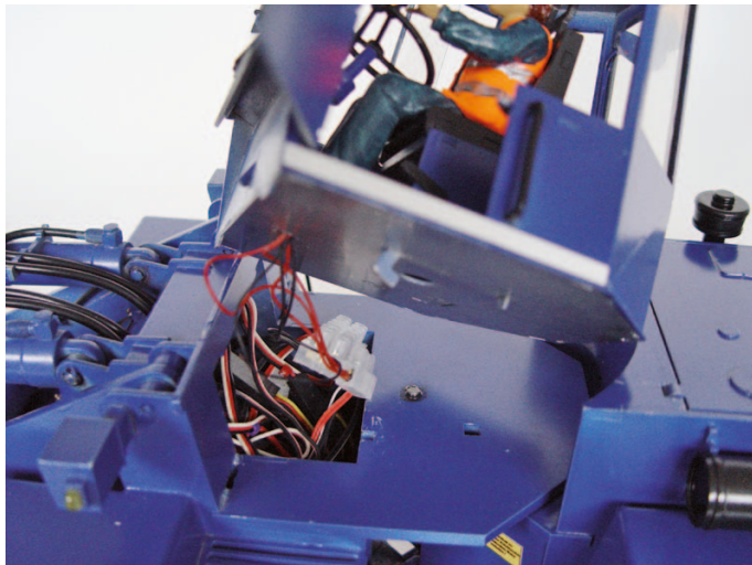
▲ Pffiffig: die Handbremse dient als Entriegelung für die Fahrekabine ▼
