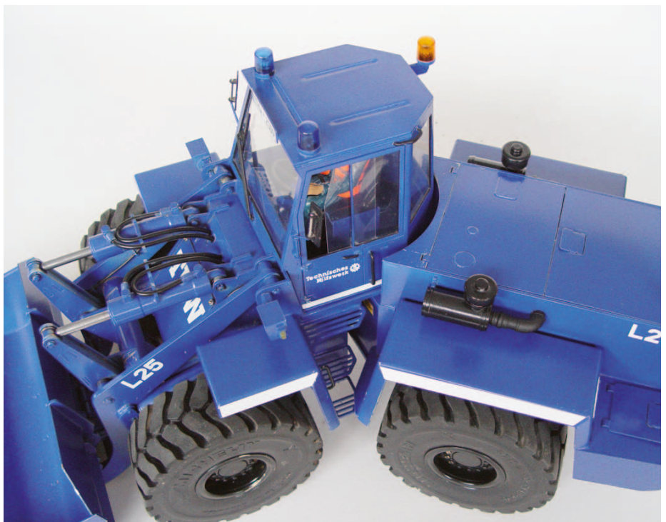
Knickgelenk auf Vollausschlag: der L25 ist extrem wendig; der Wendekreisradius beträgt nur 44 cm
