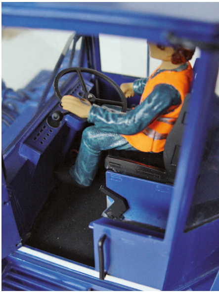
▲ Pffiffig: die Handbremse dient als Entriegelung für die Fahrekabine ▼
