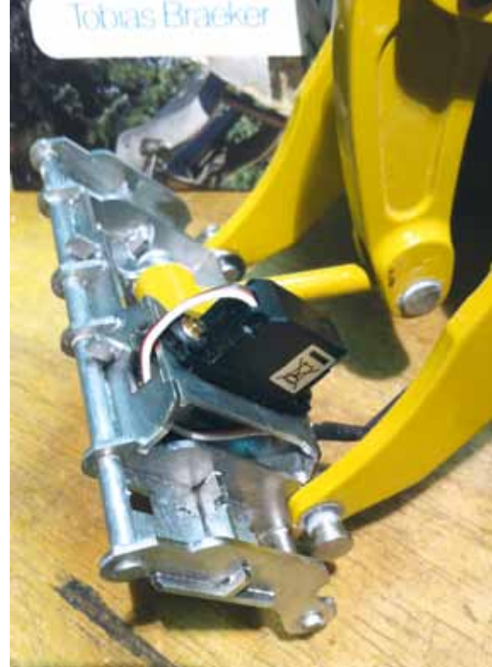
Die Verriegelung des „Braeker Lock“ mittels Mini-Servo
