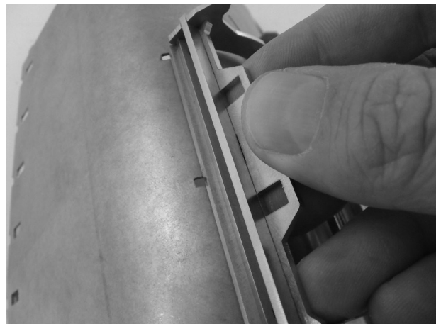
34 Schablone mittig zu den Sechskantlöchern unterschieben Push jig central under the hexagonal hole
