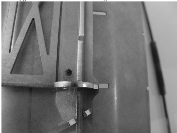
31 2x Bohrungen auf der Schaufel anreißen 2x Mark bore with scriber
