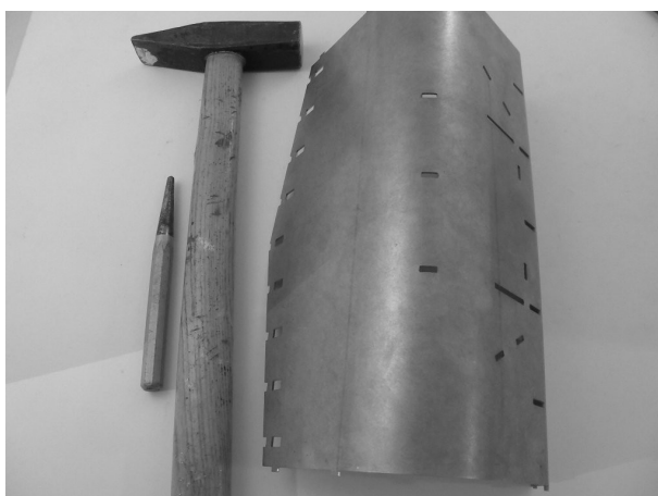
38 Lochmarkierungen können Centre punching of bore marks
